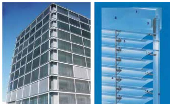
Nota\*: na aplicação do estore A2 ou AF, ter em conta que até 3000mm de largura 2 cabos, a partir de 3000mm de largura 3 cabos, a partir de 4000mm de largura 4 cabos e de 5000mm de largura 5 cabos.
